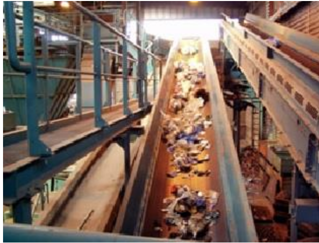
Αυτόματη μεταφορά των στερεών αποβλήτων από τις γραμμές παραγωγής κατά την επεξεργασία τους
